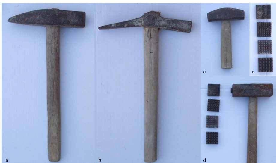
Fig. 346. Strumenti moderni da scalpellino: a) martello; b) martellina; c) mazzola; d-e) bocciarda (foto C. Ebanista; strumenti gentilmente concessi dalla famiglia Martino di Sant'Elia a Pianisi).
