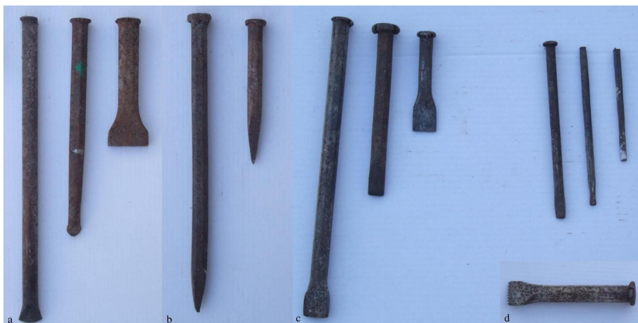
Fig. 347. Strumenti moderni da scalpellino: a) pinciotti; b) pontini; c) scalpelli; d) gradina (foto C. Ebanista; strumenti gentilmente concessi dalla famiglia Martino di Sant'Elia a Pianisi).
