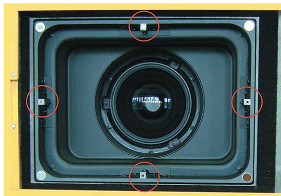
Figura 3.4 - Vista interna, dal retro, del cono oscuro di una camera metrica terrestre: sono stati evidenziati con un cerchio i quattro dispositivi responsabili della registrazione sui fotogrammi delle quattro marche fiduciali
