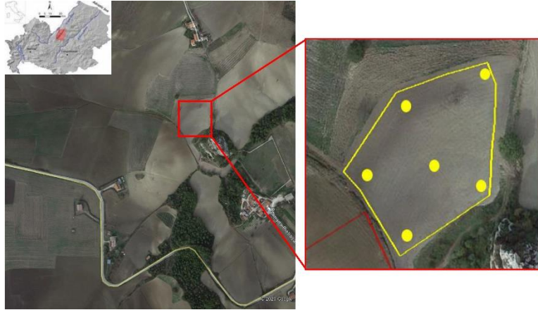
Figura 4.5 - Campo selezionato per le misure con i differenti parametri, i punti in giallo rappresentano i GCP
