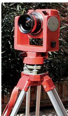
Figura 3.16 - Camera metrica Wild P31 montata su basamento della stessa ditta. Ciò permette l'intercambiabilità della camera con goniometro e mire
