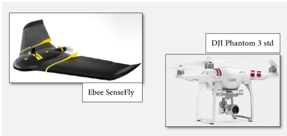
Figura 1.12 - Esempio di drone: a sinistra un drone ad ala fissa, a destra un drone multirottore (quadricottero)
