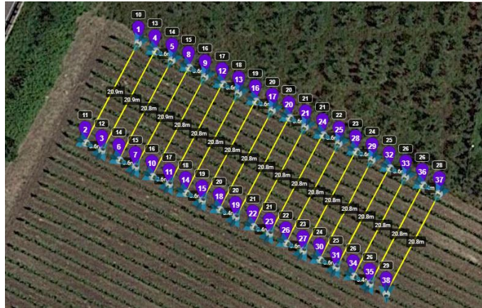
Figura 5.45 - Piano di volo del campo C2 nell'AT2 i numeri in viola indicano i vertici dei segmenti del piano di volo; i numeri di fianco quelli viola indicano la quota di volo impostata che tiene conto della quota di volo impostata, della morfologia del versante e della quota di del punto di decollo del drone; i segmenti in giallo indicano la traccia del piano di volo (in nero la lunghezza del segmento)
