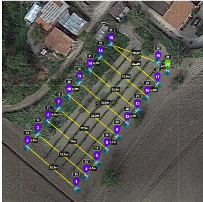
Figura 5.20 - Piano di volo per il campo C3, i numeri in viola indicano i vertici dei segmenti del piano di volo; i numeri di fianco quelli viola indicano la quota di volo impostata che tiene conto della quota di volo impostata, della morfologia del versante e della quota di del punto di decollo del drone; i segmenti in giallo indicano la traccia del piano di volo (in nero la lunghezza del segmento)
