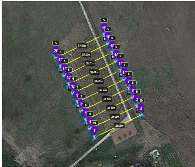
Figura 5.17 - Piano di volo per il campo C1, i numeri in viola indicano i vertici dei segmenti del piano di volo; i numeri di fianco quelli viola indicano la quota di volo impostata che tiene conto della quota di volo impostata, della morfologia del versante e della quota di del punto di decollo del drone; i segmenti in giallo indicano la traccia del piano di volo (in nero la lunghezza del segmento)
