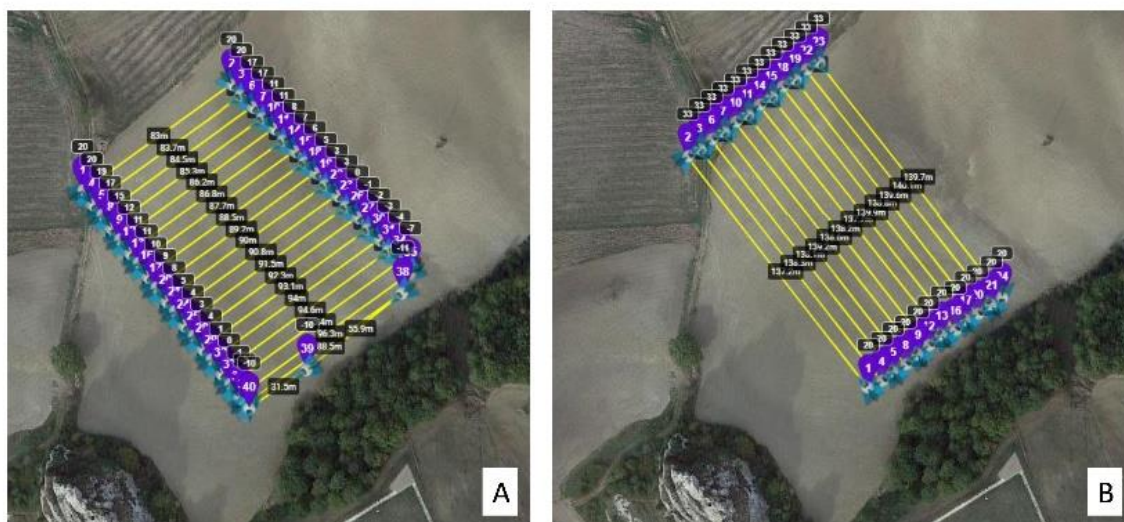
Figura 9 - Piani di volo del C4, in particolare: A) segue le curve di livello; B) taglia ortogonalmente le curve di livello. I numeri in viola indicano i vertici dei segmenti del piano di volo; i numeri di fianco quelli viola indicano la quota di volo impostata che tiene conto della quota di volo impostata, della morfologia del versante e della quota di del punto di decollo del drone; i segmenti in giallo indicano la traccia del piano di volo (in nero la lunghezza del segmento)
