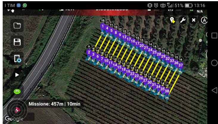
Figura 3.36 - Schermata dell'App Litchi, utilizzata per trasferire le informazioni del piano di volo in campo
