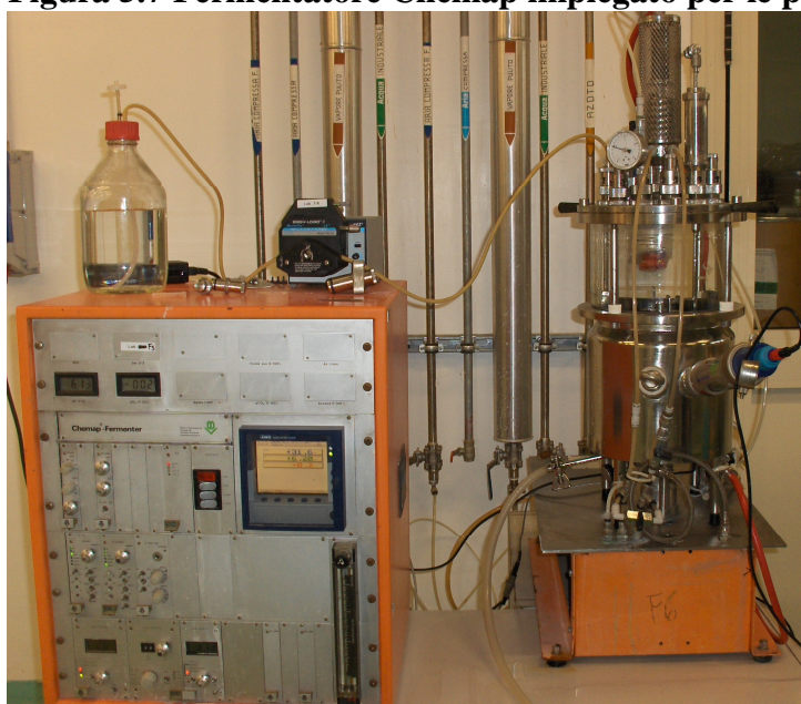
Figura 5.7 Fermentatore Chemap impiegato per le prove di industrializzazione.
