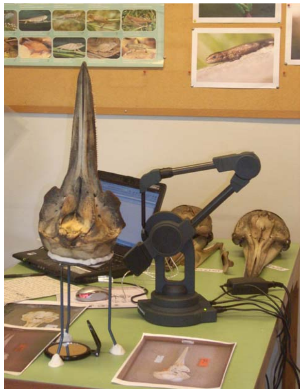
Figura 23. Posizionamento del cranio sul supporto per il rilevamento delle coordinate 3D con l'utilizzo dello scanner Microscribe (a destra nella foto).
