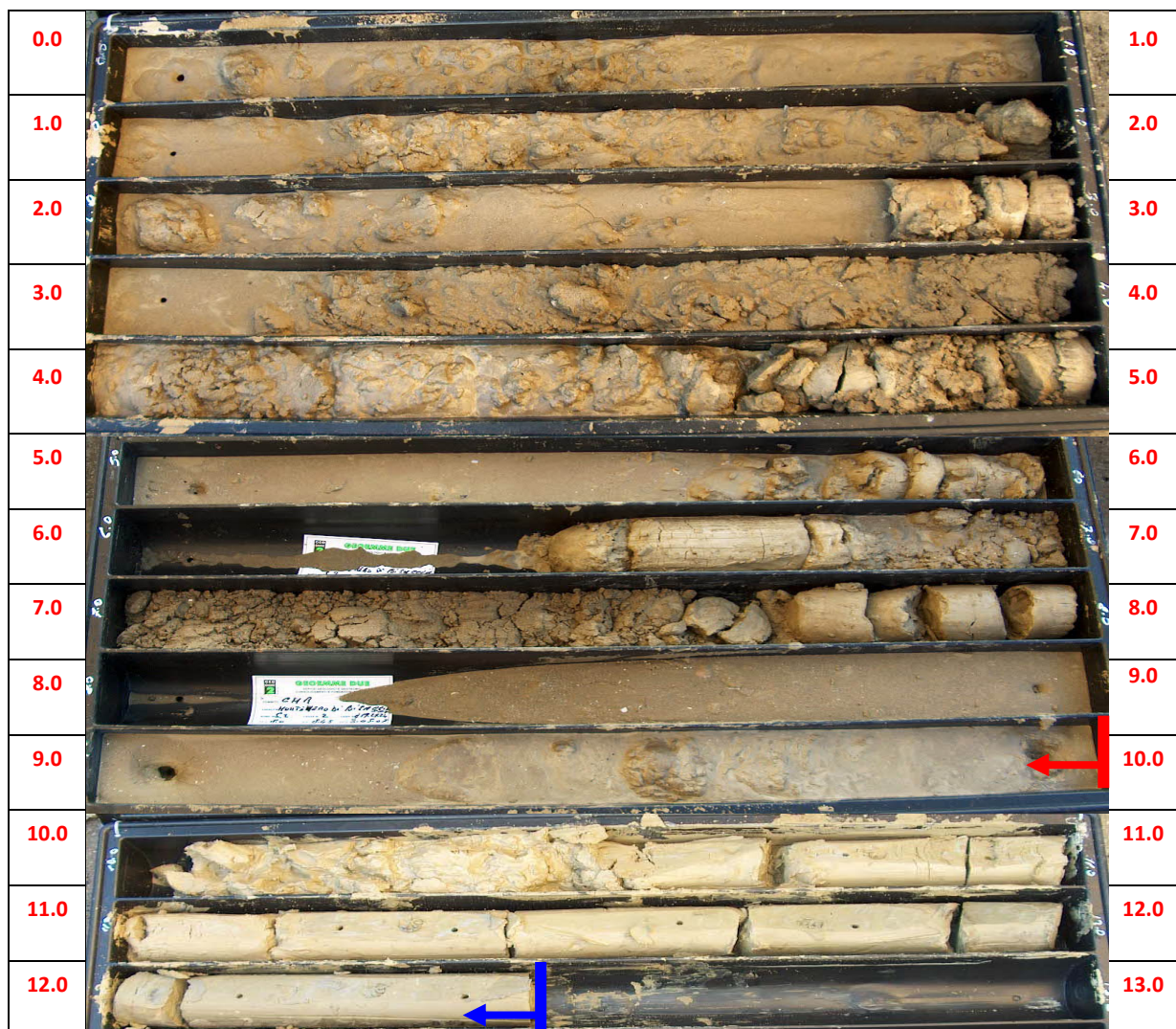
Fig. 4.1.2.2.1 - Foto della carota di sedimenti del sondaggio MBS2 con indicati i limiti inferiori delle principali unità distinte. La barra blu e la barra rossa corrispondono rispettivamente ai limiti inferiori dell'unità limoso-argillosa e dell'unità sabbiosa). La foto è stata scattata il 3-3-2007 subito dopo il prelievo a mare dei sedimenti (foto V. Bracone).
