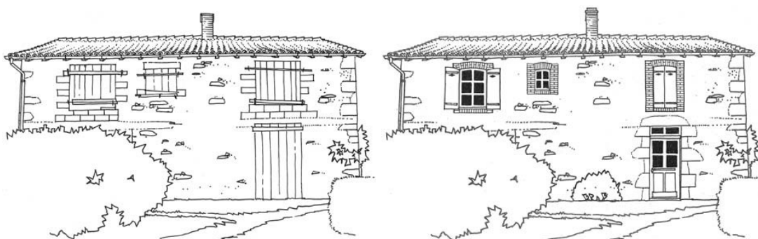
Figura 25: Esempio di cambio di destinazione d'uso di un fienile in civile abitazione: nel progetto è stato rispettata la posizione originale delle aperture, utilizzando materiali compatibili e recuperando quelli esistenti. (Fonte: Charte architecturale et paysagère)
