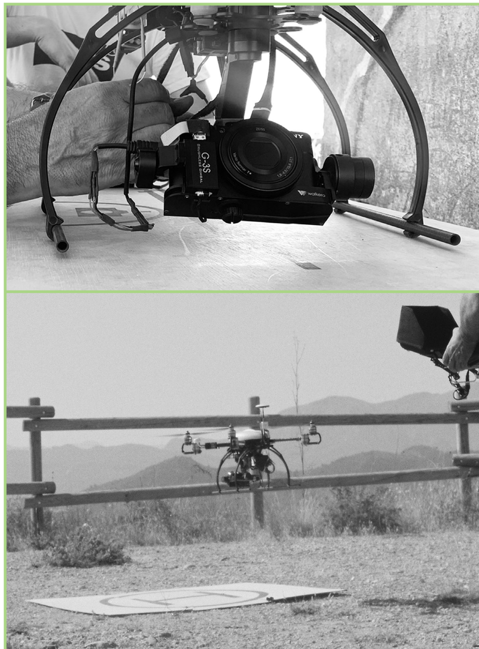
Fig. 1.12 Drone con gymball che integra la fotocamera esterna (foto dell'autore).
